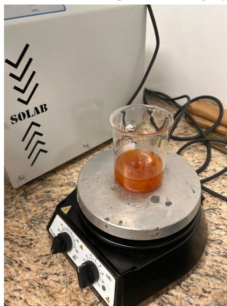
Figura 4. Sistema sob aquecimento e agitação
